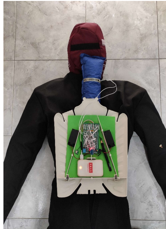
Imagen 2: Dummy con la parte del torso descubierta para poder observar los componentes hardware instalados (placa, antenas de comunicación, sensores, altavoces, batería...).
