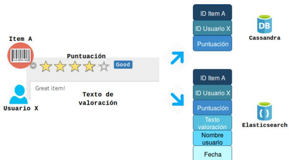
Almacenamiento de datos de valoraciones
